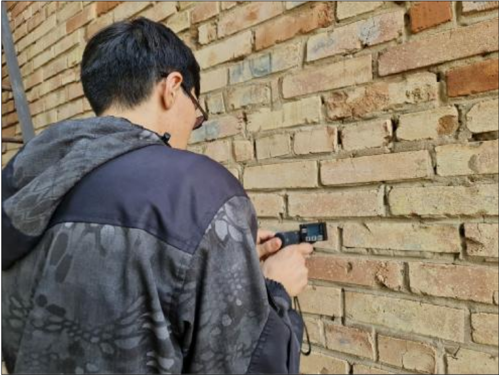
Рис. 16.1 Замеры прочности кирпича несущей стены.
